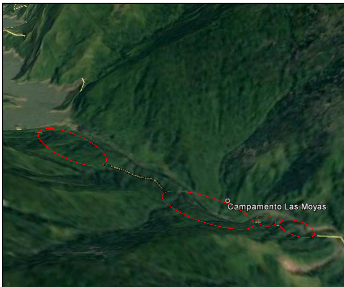
Figura 2. Detalle de la zona donde se desarrollarán las obras del proyecto actual. Los polígonos en color rojo indican los túneles construidos para la vía actual debido a lo escarpado de la topografía.
